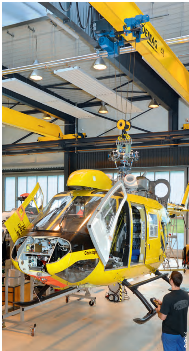
Electropalane cu cablu Demag utilizate la mentenanța elicopterelor.
