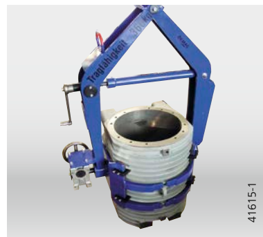
Dispozitive de rotire la 90°(stânga) și 360°(dreapta) cu reglare a axei și motoreductor cu autoblocare
