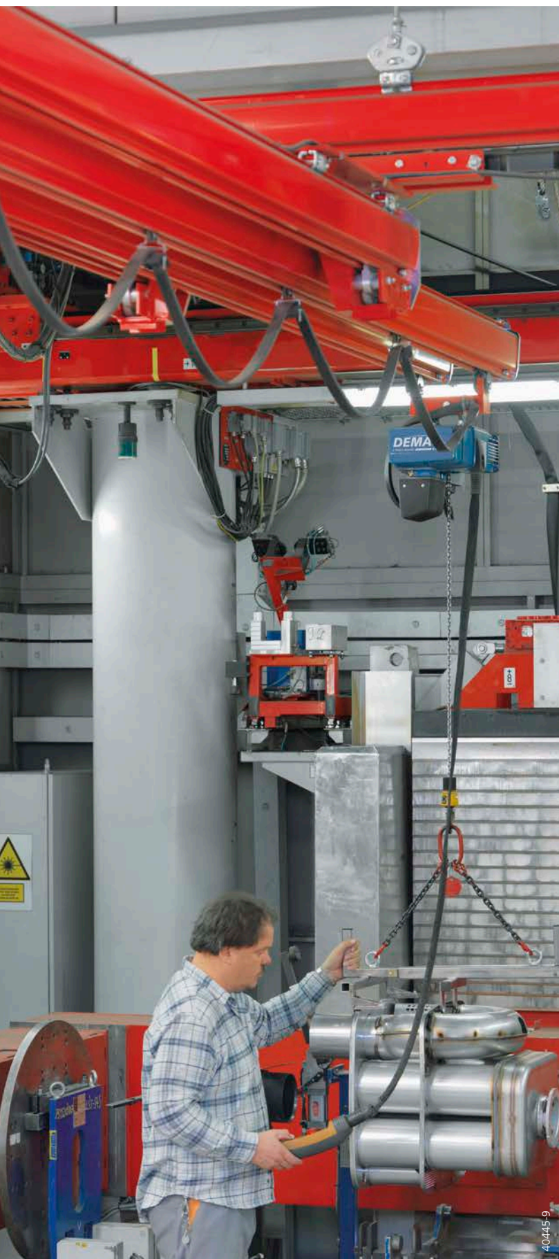
Pod rulant în consolă în versiunea monogrindă
