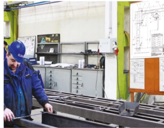
Pregătire pentru sudură manuală prin puncte. Preparing for manual tack welding.
