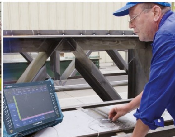
Control sudură. Welding check.
